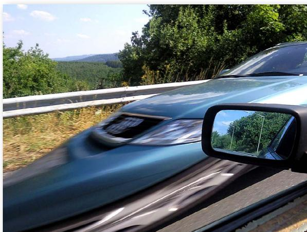
Рисунок 4 — Сравнение фотоснимков, полученных при съемке движущихся предметов (с полнокадровым и построчным переносом)<sup>3</sup>
