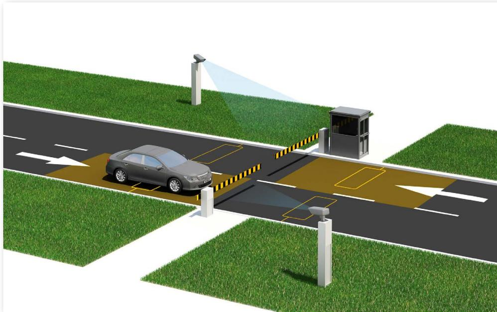
При обслуживании регулируемого пункта пропуска с воротами, ролетом или другим сплошным препятствием (см. рисунок 12) зона контроля камеры не может начинаться непосредственно на границе поста. Для фиксации транспортного средства в зоне контроля применяется стоп-линия, стоп-знак или светофор. Петля, которая запускает процесс распознавания, располагается перед передней границей зоны контроля. Петля, регистрирующая пересечение границы поста, располагается непосредственно за этой границей.
