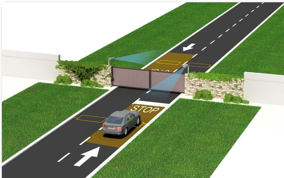
При обслуживании нерегулируемого пункта пропуска с двусторонним движением (см. [рисунок 13](#)) обязательна установка двух петель, последовательное срабатывание которых позволяет однозначно определить направление движения транспортного средства. Петли должны быть расположены по краям зоны контроля камеры (на ближней и дальней границе зоны контроля). Для ограничения скорости движения транспортного средства в зоне контроля петли могут дополняться лежащими полицейскими.
